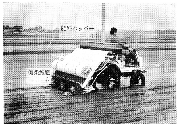
写真5 側条施肥で窒素の全量を移植時に施用する。
